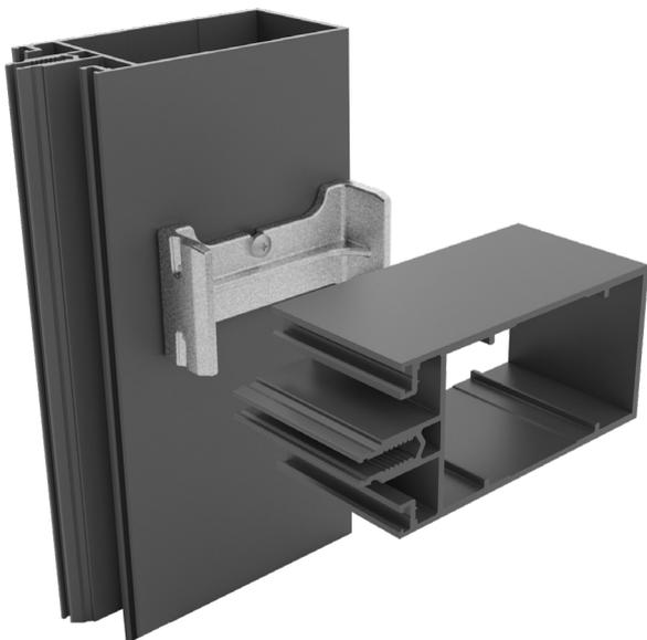
Staffa in alluminio pressofuso per il montaggio sequenziale di facciate continue. Questo sistema elimina il laborioso fissaggio tramite viti e garantisce il preciso posizionamento grazie ai fori realizzati sul montante. Con pulsanti di ancoraggio fissi e serraggio di sicurezza tramite unica vite. **Brevettato.**
