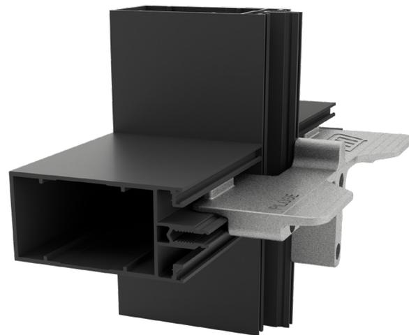
Supporto in alluminio pressofuso per vetri pesanti di facciate continue. Modulabile a seconda dello spessore delle vetrate impiegate, si assembla direttamente sulle croci tramite viti autofilettanti rendendo superfluo l'utilizzo di ulteriori sistemi di giunzione frontali. **Brevettato.**
